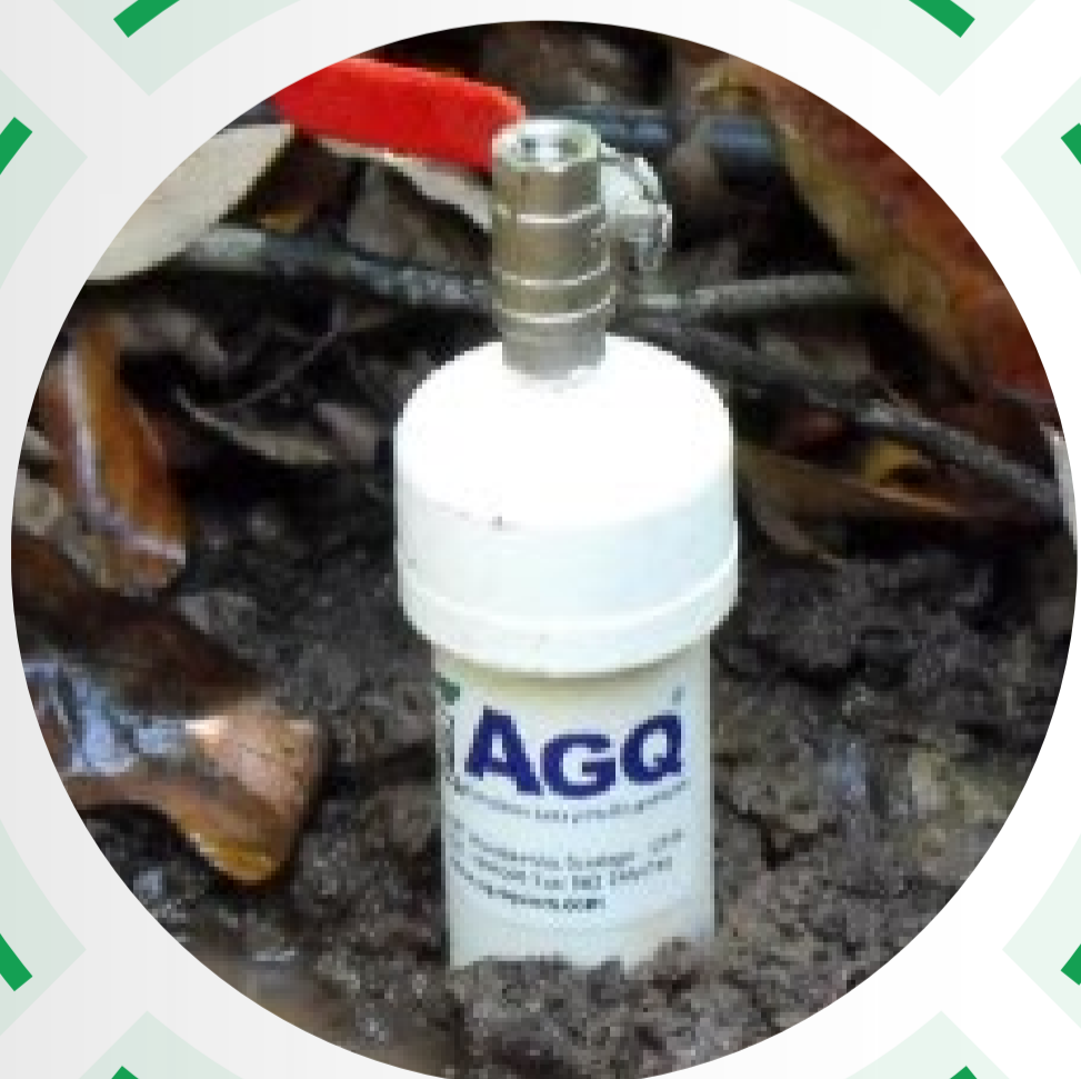
Sonda de succión utilizada para extraer la solución del suelo. La sonda en la parte inferior tiene una porcelana que simula una raíz y permite el ingreso de la solución del suelo, para su posterior análisis.
